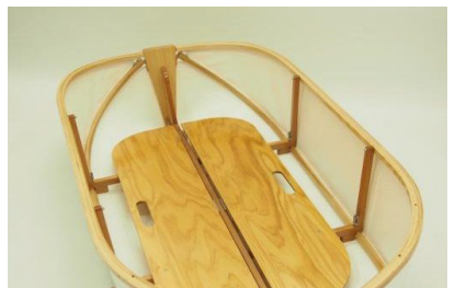
折り畳み式ボート（2 m長、1 m幅）
