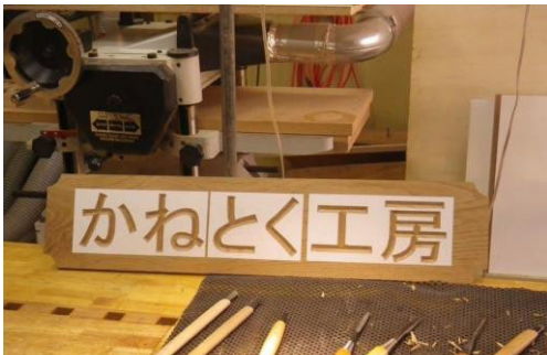
レターカービング*（薬研彫り：V溝）で製作中の看板
